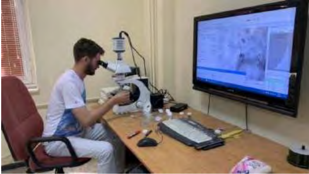
Foto 8: Umut Ocağı Karot Numunelerinden Yapılan Sıvı Kapanım Analiz Çalışması
